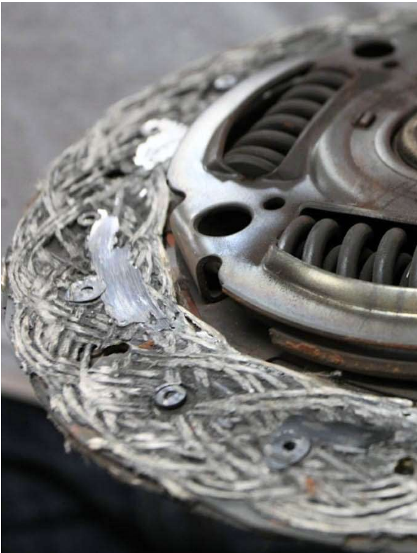
Хорошо видны четыре демпферные пружины ведомого диска сцепления, а также изношенные фрикционные накладки
